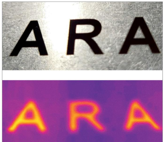
**Abb. 1:** Foto der »warmen« Laserbeschriftung auf Aluminium (oben) und Aufnahme derselben Beschriftung mit einer IR-Kamera (unten).
